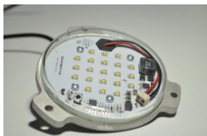
En LED-baserad ljuskälla från Aluwave
